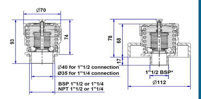
Set pressure tolerance: Max ( $\pm 3\%$ ; 0,1b/1,45 PSI)
