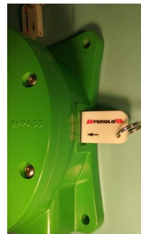
Introduction de la clé en mode « BYPASS »
